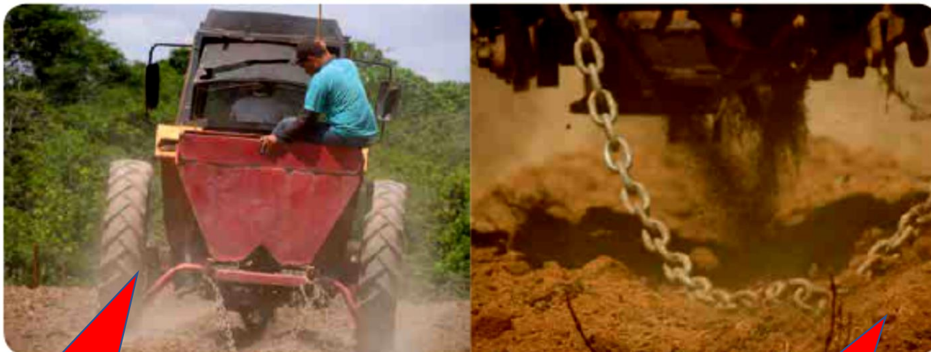
Semeadura direta sendo realizada com calcareadora adaptada. Detalhe para a saída das sementes da calcareadora sem o operador e com um sistema para enterrar as sementes.
