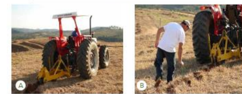
Figura 48 - Área com o mato já seco, após aplicação de herbicida, (A) sendo preparada para o plantio com um subsolador florestal e (B) técnico medindo a profundidade de subsolagem com uma haste de ferro.
