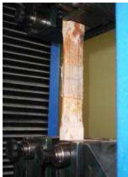
Figura 12: Ensaio de tração em madeira com e sem reforço.
