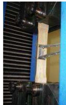
Figura 12: Ensaio de tração em madeira com e sem reforço.
